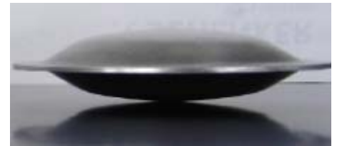
Bild 5: Vakuumdicht verschweißter Hohlkörper
