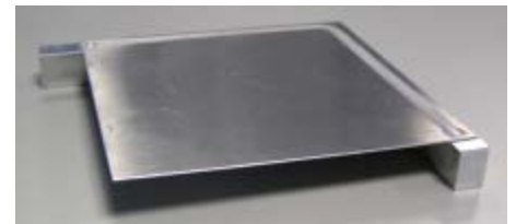
Bild 4: Auf Rahmen geschweißtes Blech, das nach der Schweißung keinen Verzug aufweist
