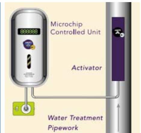
Bild 3: Kontrolleinheit und Aktivator
