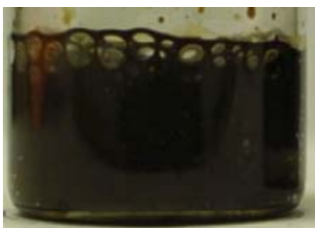
Bild 1: Emulsion aus Öl und Wasser, die durch eine schaltbare grenzflächenaktive Substanz in Gegenwart von CO 2 stabilisiert wird. Bild 2: Nach dem Schalten der grenzflächenaktiven Substanz durch Entfernung von CO 2 und Zuführung von Stickstoff (oder Luft) entmischte sich die Emulsion.
