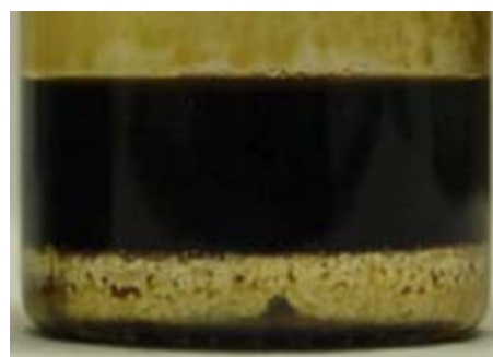
Bild 1: Emulsion aus Öl und Wasser, die durch eine schaltbare grenzflächenaktive Substanz in Gegenwart von CO 2 stabilisiert wird. Bild 2: Nach dem Schalten der grenzflächenaktiven Substanz durch Entfernung von CO 2 und Zuführung von Stickstoff (oder Luft) entmischte sich die Emulsion.
